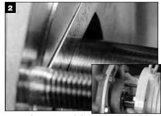
2ページの取付図面を参照して、取付寸法を 図る基準点を決定します。シャフトの基準点の ある部分にケガキ液をスプレーし、基準点を マークします。
